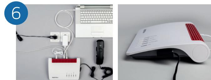
Verbinden Sie Ihr Telefon mit der ersten Telefonbuchse „FON 1“ der FRITZ!Box. Ein zweites analoges Telefon kann mit dem RJ-11-Adapter auf der Rückseite der FRITZ!Box angeschlossen werden. Alternativ kann ein ISDN-Telefon oder eine ISDN-Telefonanlage über die Buchse „FON S<sub>0</sub>“ angeschlossen werden.
