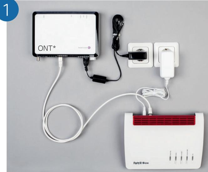
Der ONT (siehe Abbildung) befindet sich in der Regel im Wohnungsflur oder im Keller und muss am Strom angeschlossen sein. Dieser wird mit Ihrer neuen FRITZ!Box verbunden. Benutzen Sie dazu das weiße Ethernet-Kabel und stecken Sie es in die Buchse „GE 1“ und das andere Ende in die FRITZ!Box in die Buchse „WAN“.
