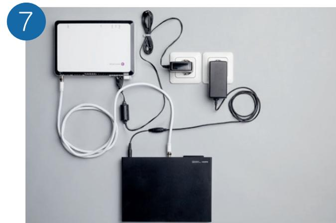
Verbindung von ONT zum Fernsehgerät mit Koaxial-Antennenkabel 75 Ohm. Auf Wunsch stellen wir Ihnen ein leistungsfähiges Kabelfernsehsignal zur Verfügung. So erhalten Sie unabhängig von Witterungseinflüssen immer ein kristallklares Fernsehbild.
