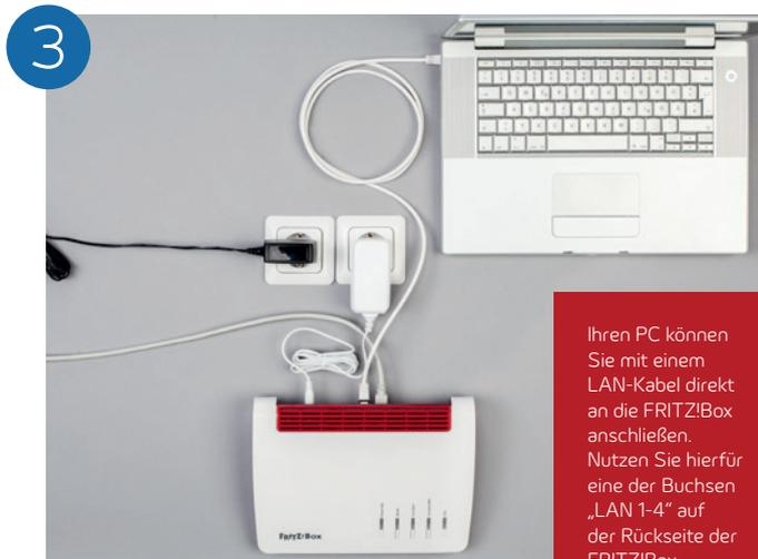
Ihren PC können Sie mit einem LAN-Kabel direkt an die FRITZ!Box anschließen. Nutzen Sie hierfür eine der Buchsen „LAN 1-4“ auf der Rückseite der FRITZ!Box.
